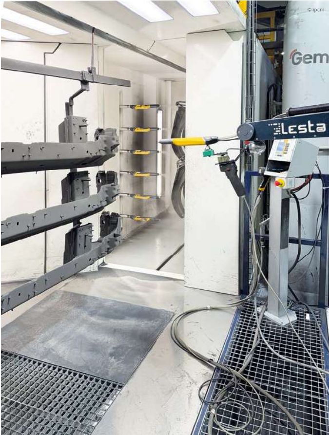
La plataforma de retoque posterior con el robot Lesta en la salida es muy amplia y tiene aspiración independiente.
